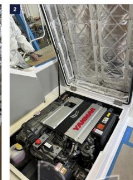
La forma delle latute cassoni impedisce il passaggio di acqua anche senza guarnizione. Molta cura è stata dedicata all'insonorizzazione, sia per la scelta del materiale che per il montaggio (foto 2).
