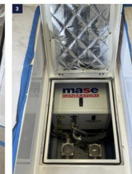
Il portello centrale sul camminamento dà accesso al gruppo elettrogeno e ai filtri acqua motori. I filtri sono muniti di valvola a 3 vie per pescaggio in sentina anziché a mare in caso di necessità forzata (foto 3).
