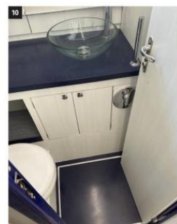
Il piano di appoggio e il pavimento sono in corian. La canale che si vede nel pavimento è la sede che porta l'acqua della doccia alla vasca con pompa elettrica automatica (foto 8 e 10).
