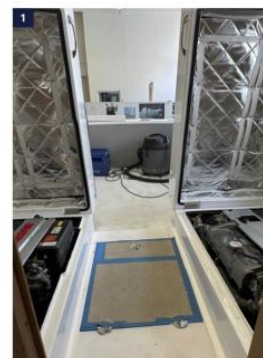
Nei due cassoni aperti è ben visibile il buon accesso ai motori sia frontalmente che lateralmente dal portello centrale (foto 1).
