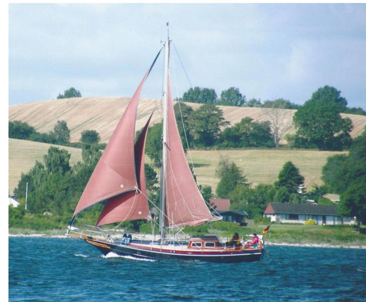
FAHRENSMANN-36 - KLIPPER GEWICHT 850 kg GEWICHT IN TONNEN 0,85 t PROF. 1000 mm KLASSE 1000 mm ANWINK. 1000 mm LÄNGE OBER STEVEN 10,70 m GRÖSSTE BREITE 3,40 m TIEFANG 1,21 m VERDRÄNGUNG 10,20 m 3 VERBAND Uecker YACHT- und BOOTWERFT RENDSBURG
