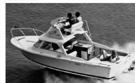
Scheda tecnica Lunghezza f.t. m 7,52, larghezza max m 3,02, immersione m 0,68, capacità serbatoio acqua litri 120, capacità serbatoio benzina litri 300.
